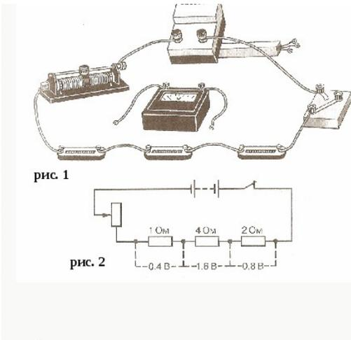
1. Для изучения распределения сил токов и напряжений при последовательном соединении проводников экспериментатор собрал электрическую цепь, показанную на рисунке 1, и получил распределение напряжений, показанное на рисунке 2.
